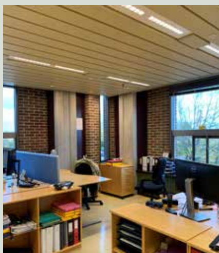
I kontorlokalerne på Gentofte Rådhus belyses vægflader for at mindske kontraster mellem vægge og vinduer.
