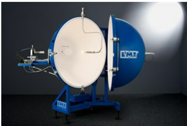
En integrerende målekugle med en diameter på ca. 1½ m. Foto: LMT.
