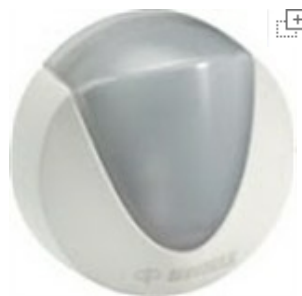
Lyssensor med indbygget lysfølsomt element, som ændrer karakteristisk afhængigt af lysstyrken. Lyssensoren sender et signal til Control-enheden, som tænder/slukker eller dæmper lyset. Foto: Servodan.
