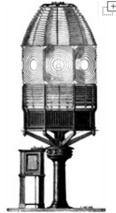
Fresnel-linser anvendt foran lyskilden i et fyrtårn. Denne linsetype er specielt velegnet her, idet der kræves et stort linseareal og pga. pladsforholdene en lille brændvidde. Figur: Gyldendal / www.denstoredanske.dk .
