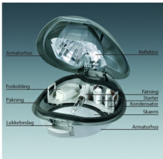
Komponenter i armaturhuset SQ50. Foto: Siteco.
