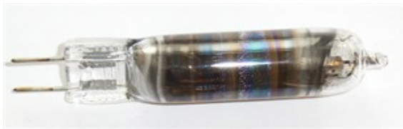
Metalhalogenlampe med utæt brænder. Gasser er kondenseret på indersiden af den ydre kolbe. Foto: Michael Raunkjær.
