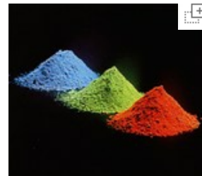
Fluorescerende pulver (lyspulver) til 3-pulver-rør er sammensat af tre fosfortyper, som her er udsat for UV-stråling. Figuren viser, at de tre komponenter hver især omdanner UV-strålingen til lys af farverne blå, rød og grøn. Med en passende vægtning af de tre farver i lyspulveret fås (additivt) farven hvid.
