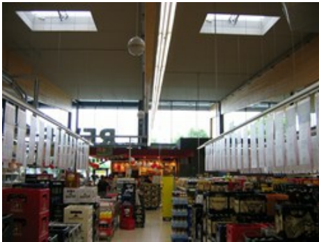
Ovenlyset i et supermarkedet i Berlin reducerer el-forbruget til elektrisk belysning. Foto: Werner Osterhaus.
