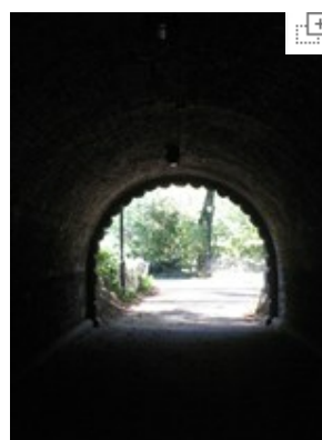
Når vi passerer en tunnel, kan vi somme tider opleve stort luminansspring mellem den mørke tunnel og de lyse omgivelser, vi kommer ud i. Foto: Astrid Espenhain
