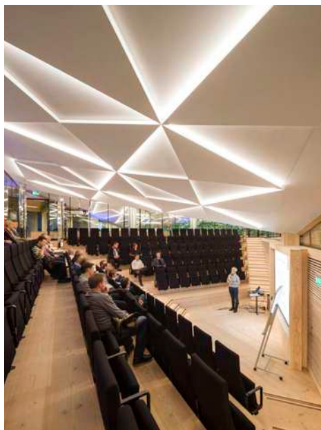
Det store auditorium, hvor LED-lyset i trekantederne er suppleret med integrerede spots, som giver en direkte belysning der, hvor der er behov for det. Foto: Adam Mørk.
