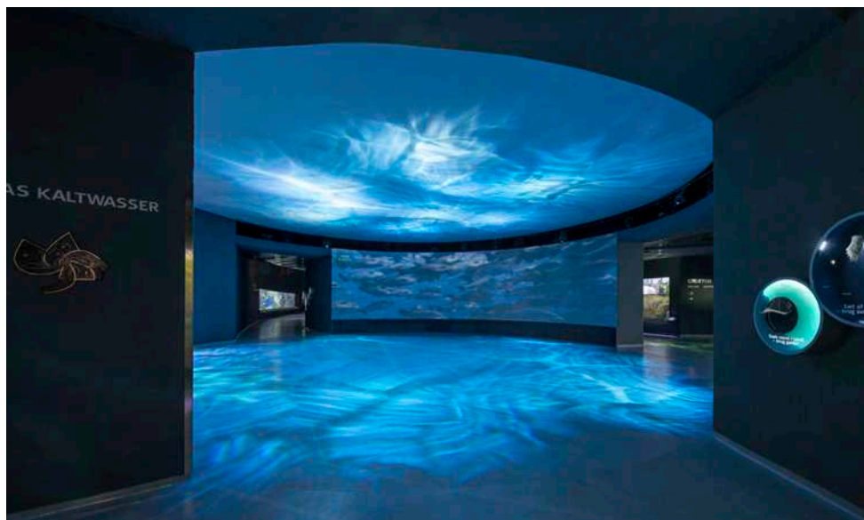
Vandeffekterne er skabt med en særlig lysmaskine (Rosco X-24), der ved hjælp af to roterende glasskiver og et mekanisk dæmperhjul kan styres via DMX-protokol. Foto: Adam Mørk.
